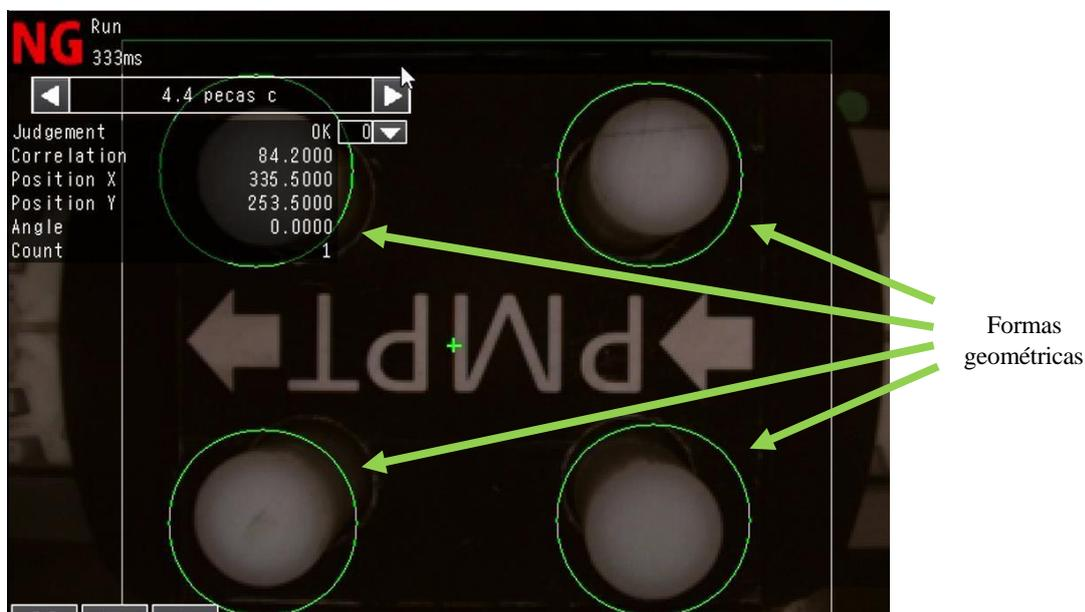
Figura 97: Definição das formas geométricas no software *TouchFinder*.
