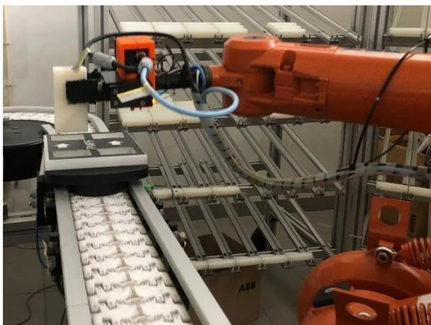
Figura 67: Correção do posicionamento das peças na paleta.
