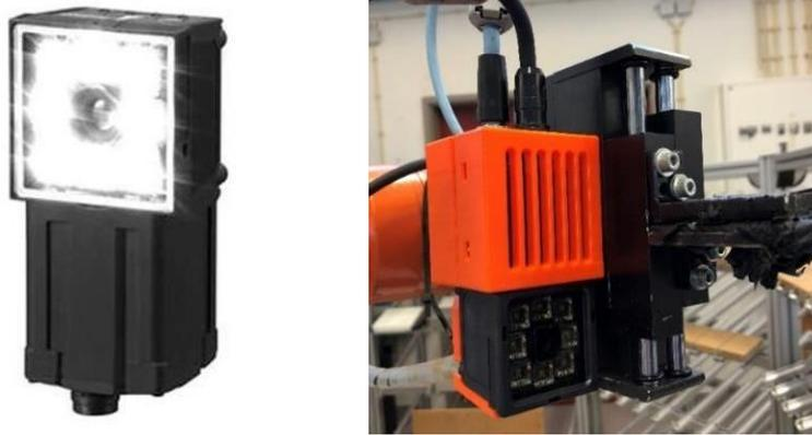
Figura 80: Câmara de visão FQ2 instalada na CFF.
